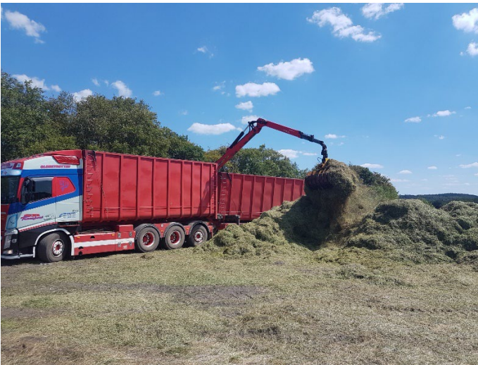
Høsten 2018. Lastbilkran fylder og komprimerer biomassen i containere
