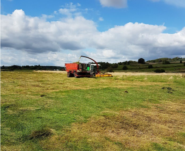
Høstmetode 2017: En høstmaskine og 2 stk. frakørselsmaskiner og aflæsning direkte ned i lastbilcontainere
