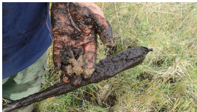
Her er der fundet sand, dvs. et vandførende lag, i 3 m dybde, men der er også vandførende lag, hvor tørvten er mere porøs dvs. svagere omdannet og med mange planterester.
