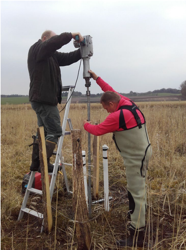
Vandrør bankes ned med elektrisk hammer til et vandførende lag i 4,5 m dybde ved Halkær Sø
