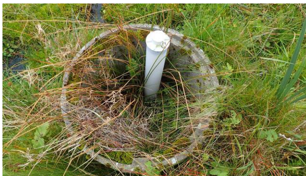
Det "våde" NOVANA-vandstandsprøvefelt ved Ulvholm Slot er meget vådt, inde i betonrøret står der blank vand med liden andemad og sideskærm. Betonrøret er med tiden sunket, så vandstandsørret nu rager et stykke op over kanten.
