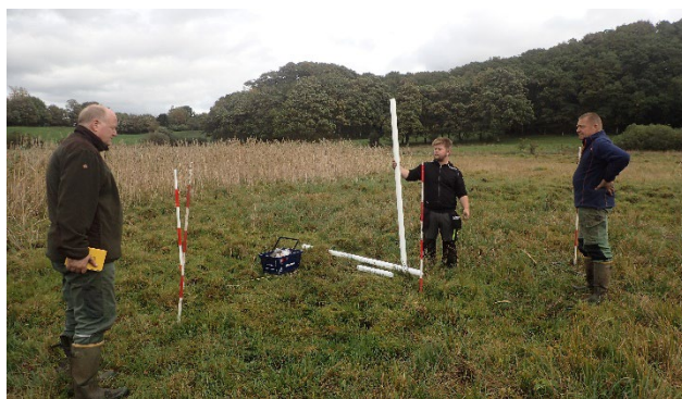
Længden af det Dybe vandstandsør afpasses efter det vandførende lag
