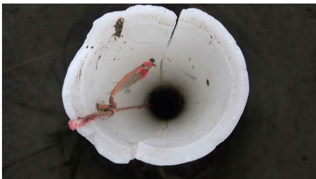
Det "tørre" NOVANA-vandstandsprøvefelt ved Ulvholm Slot er sat i en landbrugsør af beton. Røret er hårdt medtaget – ved ankomst lå T6-proppen ved siden af røret og røret er flækket på langs. Om det er frostsprængning eller hærværk er uvist, men man kunne få mistanke om at røret er banket længere ned i jorden.
