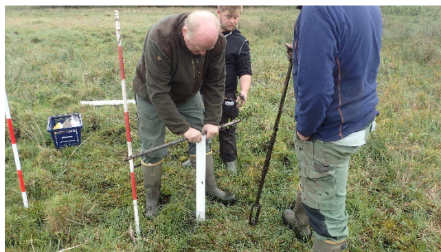
Det Dybe vandstandsør sættes, så der er 20 cm filter i den dybde, det vandførende lag er fundet
