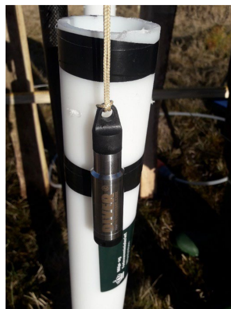
Diver hænges op i en snor nede i røret, under vandoverfladen. Den måler trykket under vandsøjleens vægt, hvilket fratrasket lufttrykket kan omregnes til en vandstand.
