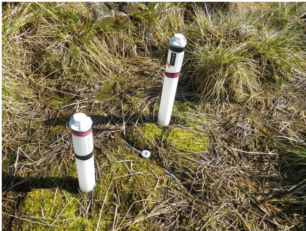
Terrænfikspunkt (jordskrue) med tværpind i hængesækken ved Bredsgård Sø, Ringe.
