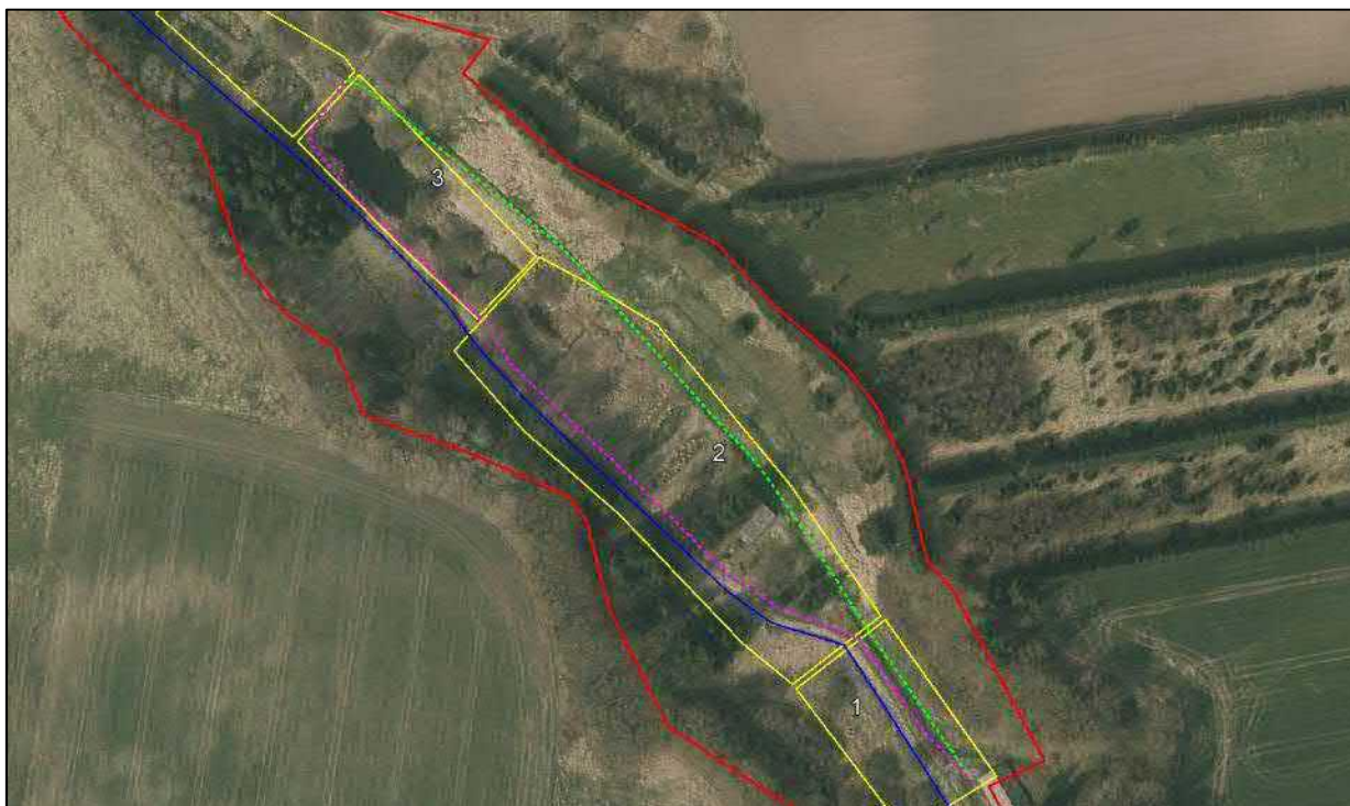
Figur 13. Placering af ekst. kabel (grøn) og mulig ny placering (lilla).
